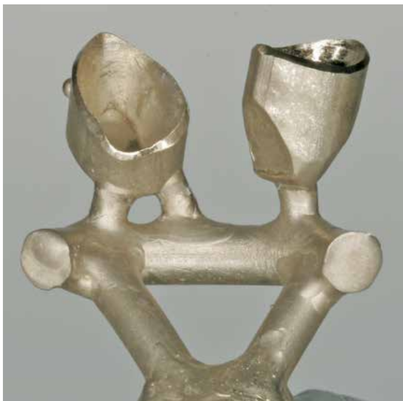
Abb. 19: Ein perfekter Guss mit der Legierung Argenco Bio Light.
