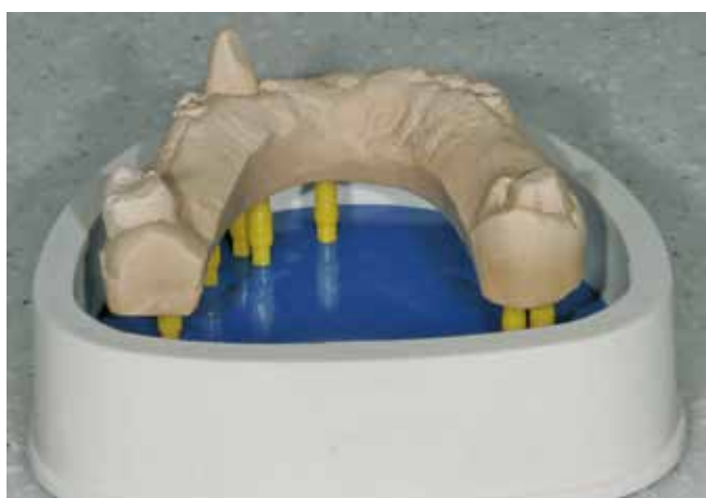
Abb. 8: Herstellung des Split-Sockels.
