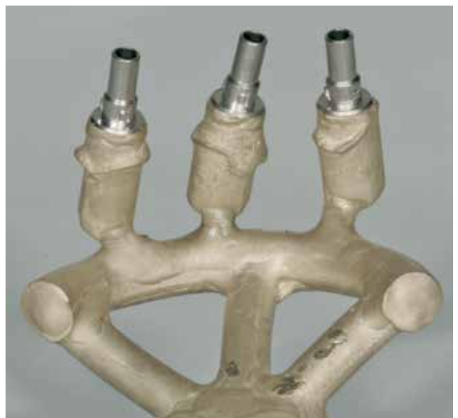
Abb. 42: Ein perfekter Guss ohne Fehlstellen, wieder aus Argenco Bio Light.
