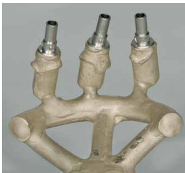
Abb. 42: Ein perfekter Guss ohne Fehlstellen, wieder aus Argenco Bio Light.
